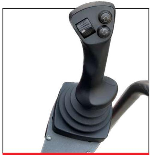
Joysticks – die hydraulische (Niederdruck) Vorsteuerung oder elektrische Steuerung
