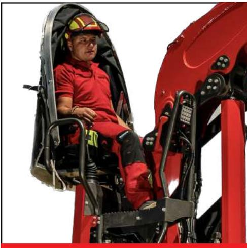
Hochsitz mit mechanischer Kreuzhebel Steuerung
