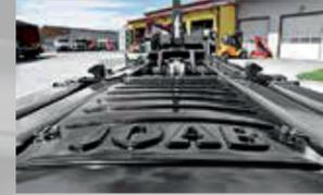
Keine überragenden Teile (komplette Verriegelung: Zylinder, Ventile und Schläuche)
