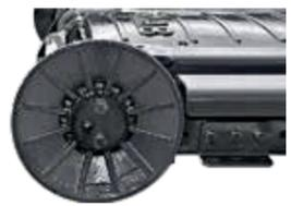
7 Groß dimensionierte Abgleitrolle
