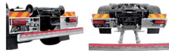
Mechanisch oder hydraulisch ausziehbarer Unterfahrerschutz
