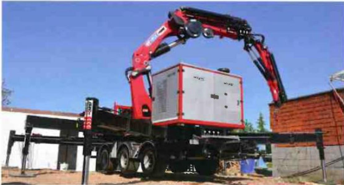
Autonom betriebener Anhänger mit 6-facher Abstützung und hydraulischer Zwangslenkung – Infos unter [www.dunst-hydraulik.com](http://www.dunst-hydraulik.com)
