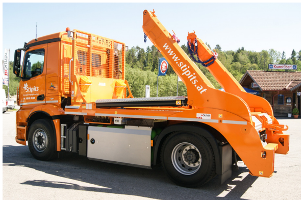
Einer der beiden JOAB Absetzkipper TL 14, die bei der Firma Stipits im Einsatz sind
